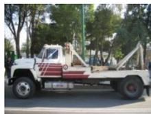
**GRUA TIPO "D"** Capacidad 25 toneladas Se utiliza para proporcionar el servicio de arrastre preferentemente a autobuses cuyo peso vehicular no exceda de 17,000 kgs., y a tracto-camiones con semirremolque cuyo peso vehicular no exceda de 18,000 kgs.
